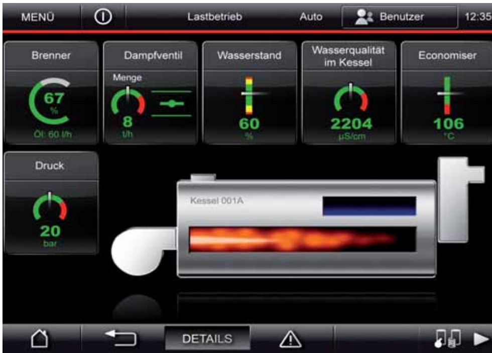
Zu jedem Zeitpunkt detaillierte Informationen über den Betriebszustand des Kessels
