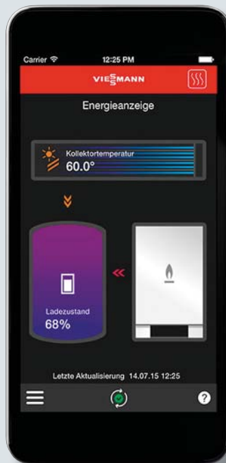
Komfortable Anzeigen im Energie-Cockpit der App auf dem Smartphone: Über die Sonnenkollektoren wird der Warmwasserspeicher mit 52,5 °C aufgeladen – bisher sind 68 Prozent erreicht.
