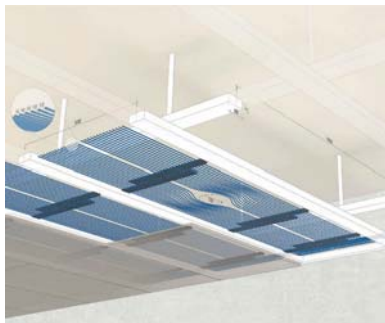
System zur Montage hinter der Gipskartondecke
