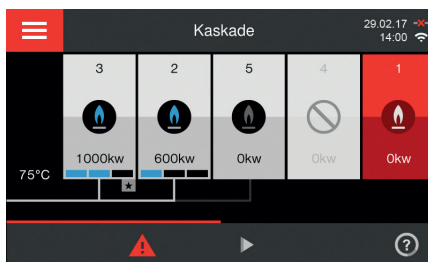
Display der witterungsgeführten Kessel- und Heizkreisregelung Vitotronic 300 (Typ CM1E)
